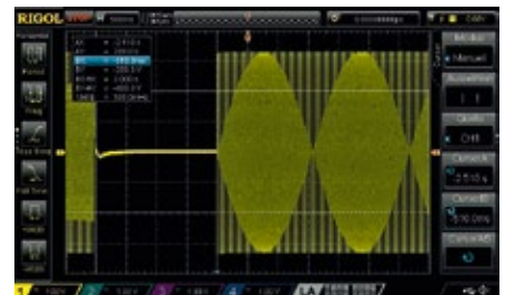
Umschaltzeit Landstrom/Inverter in beide Richtungen: 2 sec.
