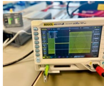
Umschaltzeit Landstrom/Inverter in beide Richtungen: 2 sec.
