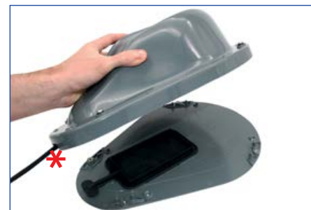
Afb. 4: Plaats de Outdoor Unit weer op de montageplaat. Houd hierbij de kabel* vast zodat hij niet uit de geleidegroef glijdt.
