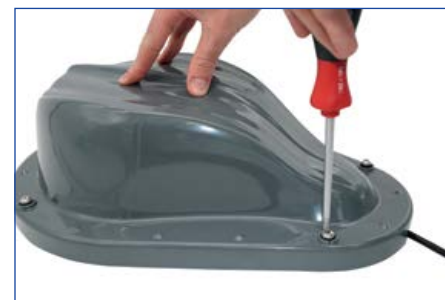
Afb. 5: Druk de Outdoor Unit omlaag op de montageplaat en draai de vier schroeven met een handschroevendraaier weer aan. Neem hierbij het maximum aanhaalmoment van 1 NM in acht!
