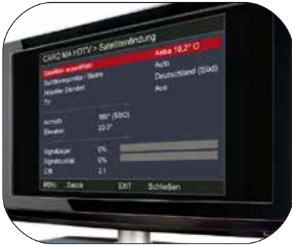
Optische Signalanzeige am Receiver als Ausrichthilfe.
