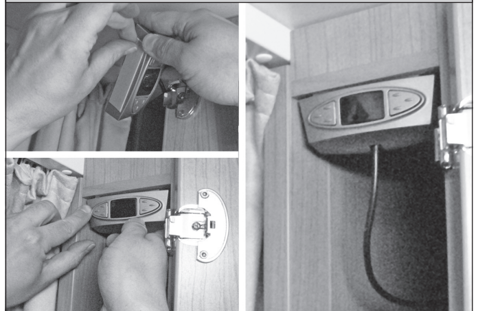
6. Beispiel: Anbringung der Sat-Maus / example: fixing Sat-Mouse / exemple ajouter la Sat-souris
