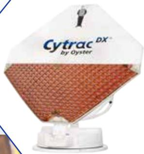
La pièce maîtresse du Cytrac® DX consiste en 1.016 antennes individuelles couplées et disposées en nid d'abeille. Une séparation soigneuse des circuits entre les deux plans de polarisation élimine toute diaphonie et assure une pureté du signal encore jamais atteinte, particulièrement intéressante en ce qui concerne les chaînes HD.
